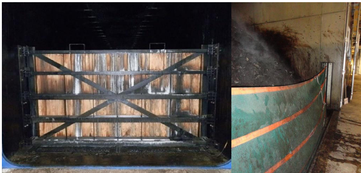
Abbildung 12: Rotteboxen mit Staugatter oder Rottenetz
