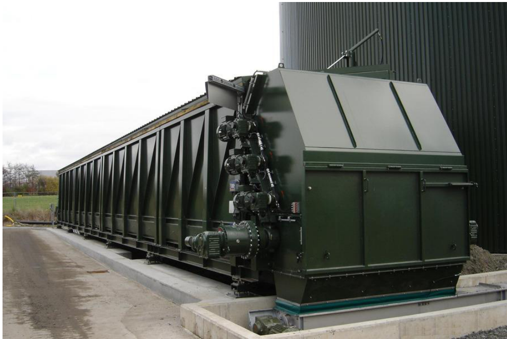
Abbildung 8: Beispiel Zwischenbunker in Stahlbauweise
